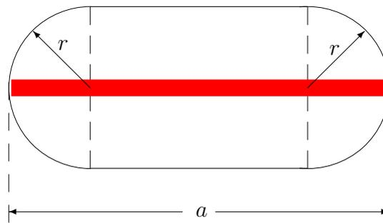
Das Fahrzeug soll mit (betragsmäßig) konstanter Geschwindigkeit  $v$  fahren. Diese wird so gewählt, dass das Fahrzeug gerade noch nicht aus der Kurve fliegt. Hieraus ergibt sich  $v = b \cdot \sqrt{r}$  mit einem festen Faktor  $b > 0$ .
